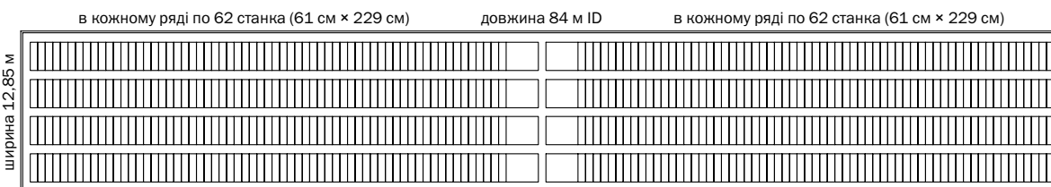
Рис. 1. ДІЛЯНКА ОЧІКУВАННЯ на 500 свиноматок до реконструкції (індивідуальні станки)
